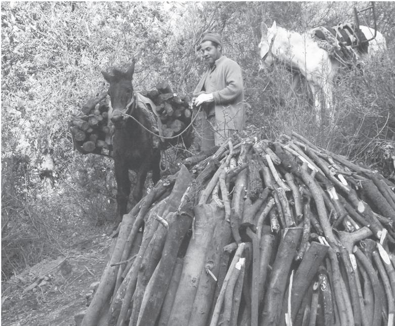
Fig.111. Proceso de encastillado para fabricar la hornilla u horno de carbón.
