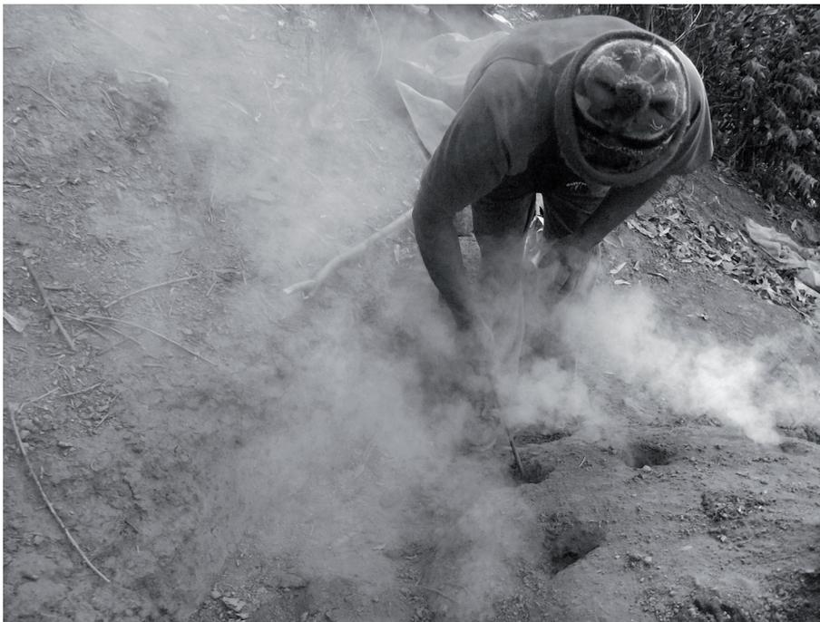
Fig.104. Carbonero destapando las filas o troneras de la hornilla.
