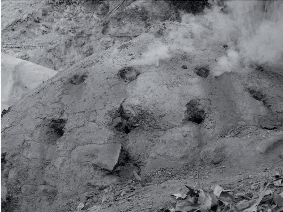
Fig. 110. Hornilla encendida saliendo humo de las filas o troneras.
