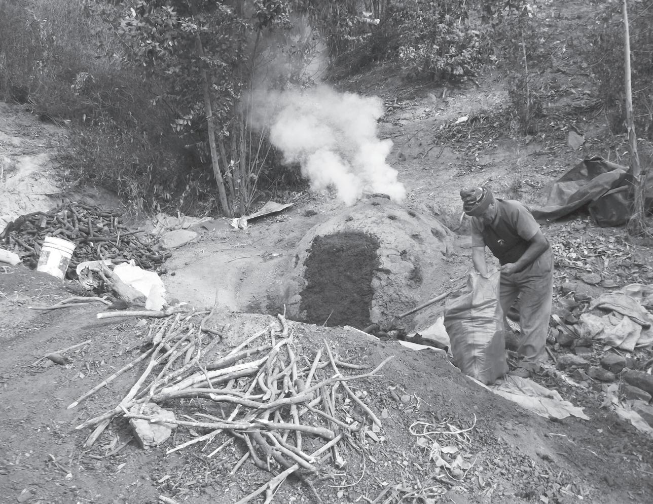
Fig. 103. Carbonero César Altamirano, envasando carbón con la hornilla encendida.
