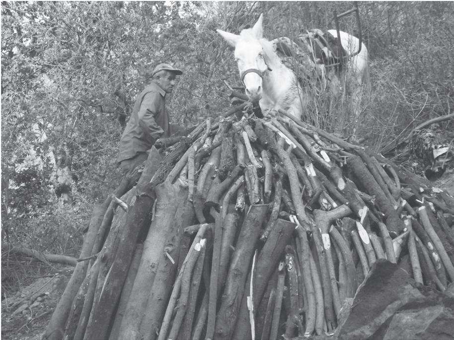
Fig.105. Carbonero encastillando para fabricar la hornilla de carbón.
